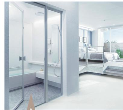
2000年代には新しい技術が次々と投入され、新たなフェーズに突入。中でもカラリ床<sup>(※4)</sup>は、床の表面に多数の溝を刻み、水滴をできるだけ残さず図ベりにくい床を実現。気密性が高いことからどうしても乾きにくかったユニットバスに大きな革命をもたらしました。
